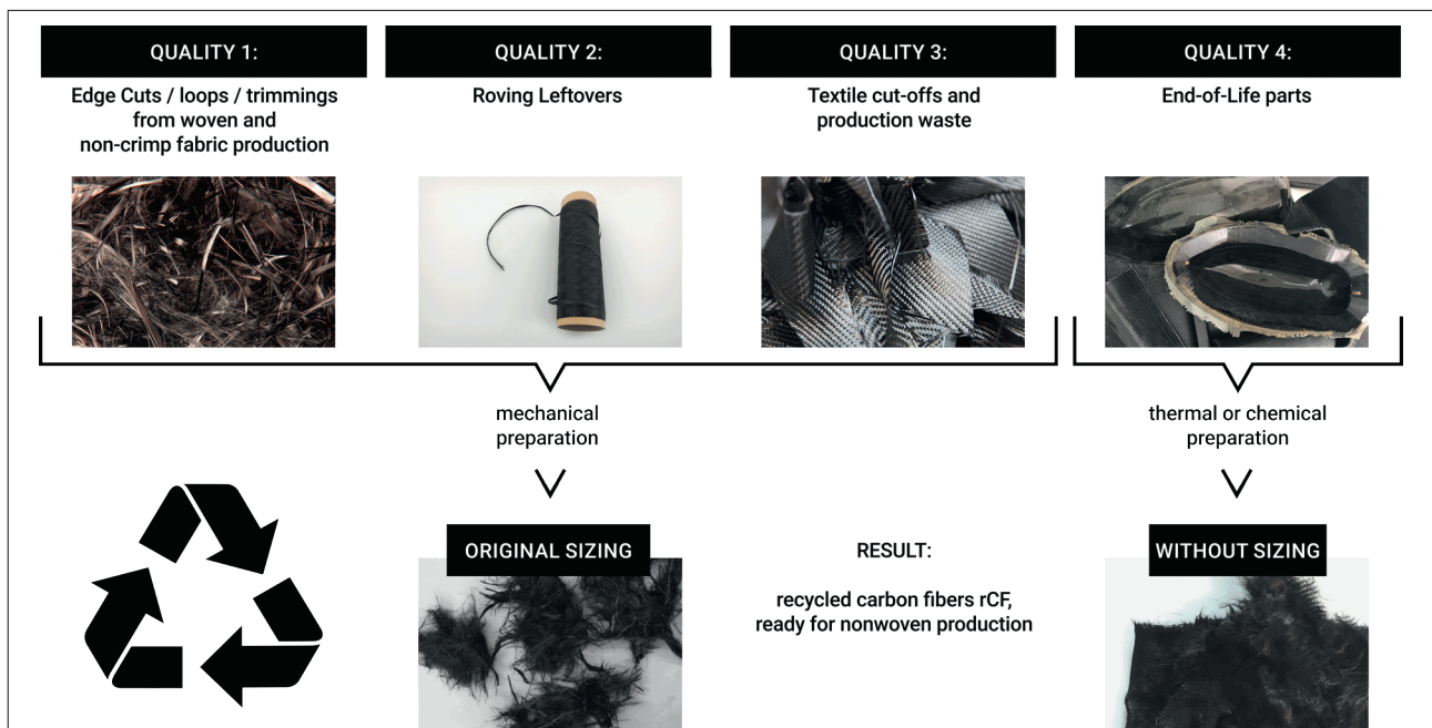
Abb. 2: Verwendete Stoffströme für die Herstellung von Carbonfaservliesstoffen.
